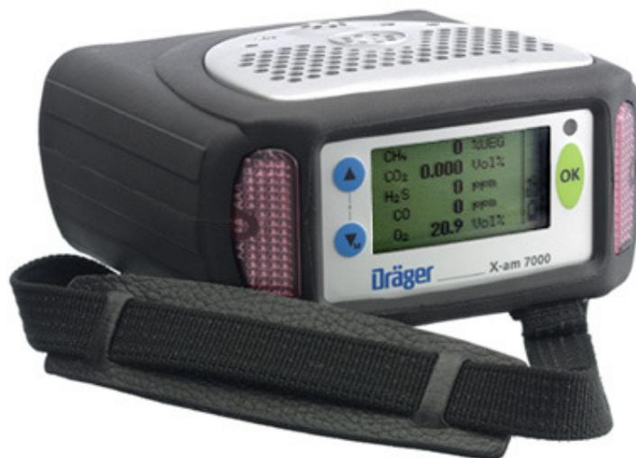
Nuevo detector múltiple de gases, configurable con 3 sensores EC (electroquímicos) y 2 sensores Cat Ex (catalíticos) o IR (infrarrojos) o un Cat Ex y un IR. Todas estas posibles alternativas, con los más de 25 sensores Dräger para la medida de alrededor de 100 sustancias, lo convierten en el equipo más completo y versátil del mercado.
